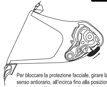
Per bloccare la protezione facciale, girare la leva di bloccaggio in senso antiorario, all'incirca fino alla posizione di ore 2. Testare ora la protezione facciale per verificare che sia bloccata correttamente.
