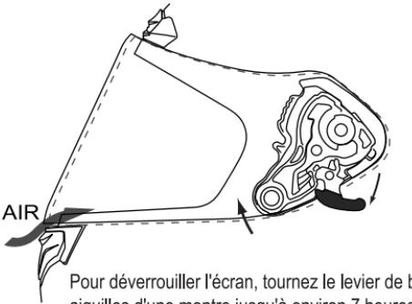
Pour déverrouiller l'écran, tournez le levier de blocage dans le sens des aiguilles d'une montre jusqu'à environ 7 heures. Vérifiez que l'écran est correctement déverrouillé.
