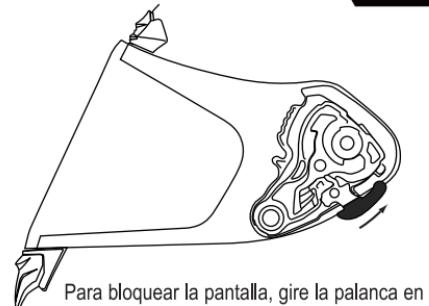
Para bloquear la pantalla, gire la palanca en sentido contrario a las agujas del reloj hasta la posición de las 2 horas aproximadamente. Pruebe ahora la pantalla para comprobar si está adecuadamente bloqueada.
