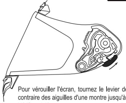
Pour verrouiller l'écran, tournez le levier de blocage dans le sens contraire des aiguilles d'une montre jusqu'à environ 2 heures. Vérifiez si l'écran est correctement verrouillé.
