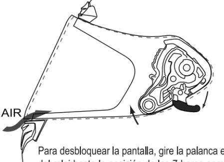
Para desbloquear la pantalla, gire la palanca en el sentido de las agujas del reloj hasta la posición de las 7 horas aproximadamente hasta que se desbloquee. Pruebe ahora la pantalla para comprobar si está adecuadamente desbloqueada.
