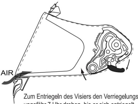
Zum Entriegeln des Visiers den Verriegelungshebel im Uhrzeiger auf ungefähr 7 Uhr drehen, bis er sich entriegelt.
