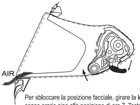
Per sbloccare la posizione facciale, girare la leva di bloccaggio in senso orario sino alla posizione di ore 7. Testare ora la protezione facciale per verificare che sia sbloccata correttamente.
