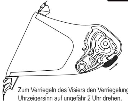
Zum Verriegeln des Visiers den Verriegelungshebel entgegen dem Uhrzeigersinn auf ungefähr 2 Uhr drehen.
